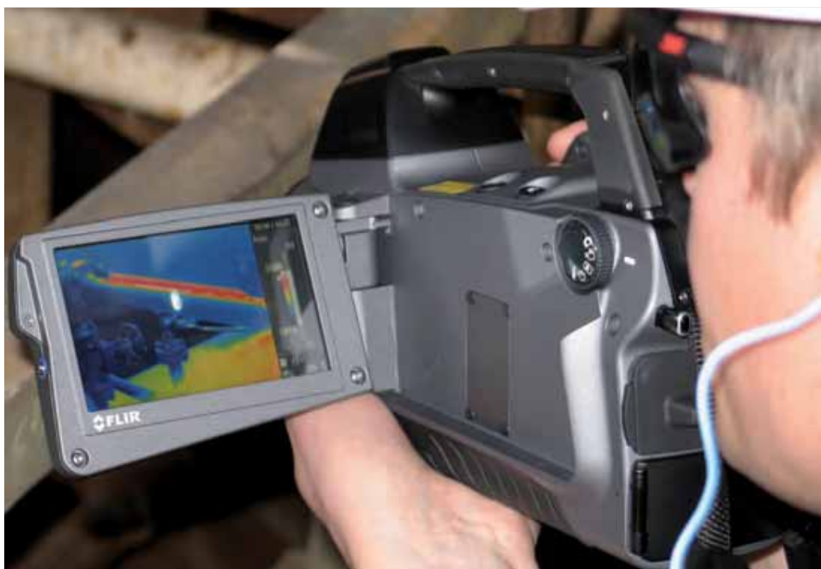
図3. LCDスクリーン上でガスの雲の画像をリアルタイムで表示可能
