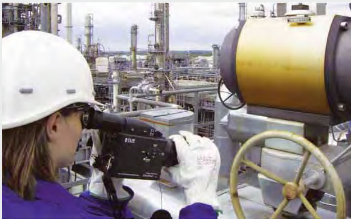
漏れ経路の検査
