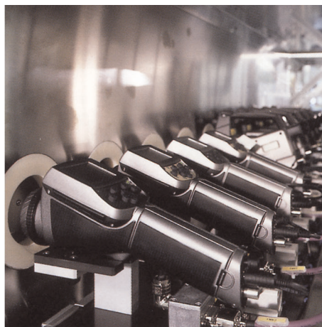
図 25.5 左: 環境ルームでの赤外線カメラの試験。右: カメラテストおよびキャリブレーション用ロボット
