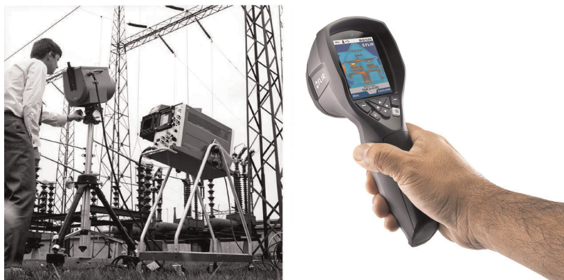
図 25.2 左: ThermoVision Model 661、1969 年発売。カメラの重量は約 25 kg、オシロスコープは 20 kg、三脚は 15 kg です。オペレータは 220 VAC ジェネレーター セットと、液体窒素の入った 10 L 容器も必要です。オシロスコープの左側には、ポラロイドのアタッチメント (6 kg) があります。右: FLIR i7、2012 年発売。重量: 0.34 kg、バッテリーを含む
