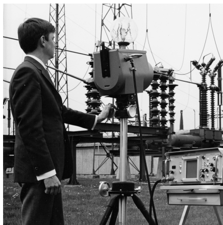
1969 年: Thermovision モデル 661。カメラの重量は約 25 kg、オシロスコープは 20 kg、三脚は 15 kg です。操作するには、220 VAC ジェネレーター式と 10 L の液体窒素が必要でした。オシロスコープの左にはボラロイドカメラ (6 kg) が取り付けられているのが見えます。
